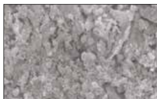
3 Остаточные силикаты на керамике, после протравливания плавиковой кислотой в течение 90 секунд с использованием Porcelain Etch.
